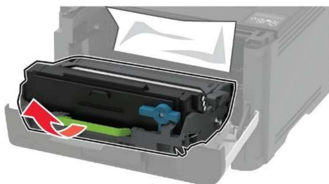
Рисунок 29 – Извлечение блока формирования изображения.
