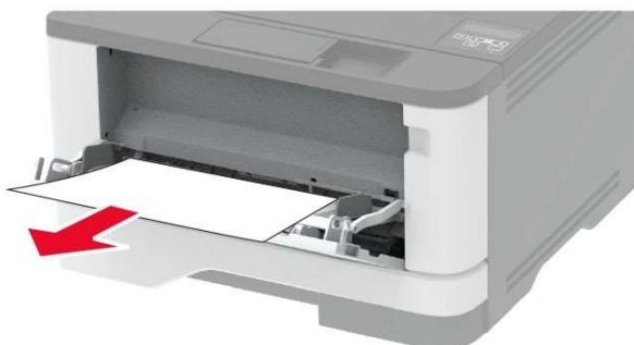
Рисунок 19 – Извлечение замятой бумаги из многоцелевого устройства подачи.
