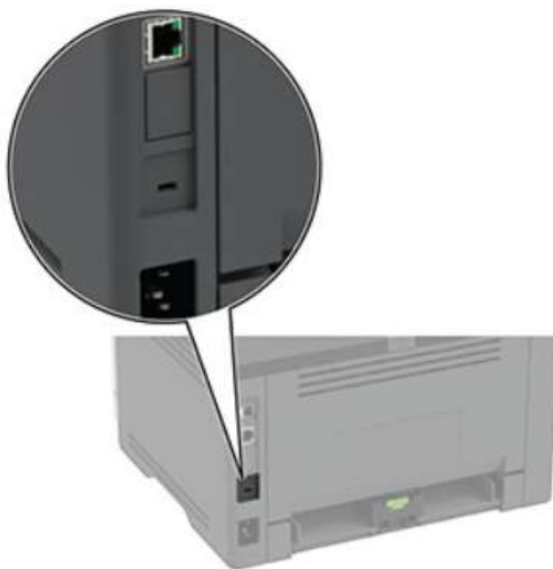
Рисунок 15 – Расположение гнезда секретного замка безопасности.
