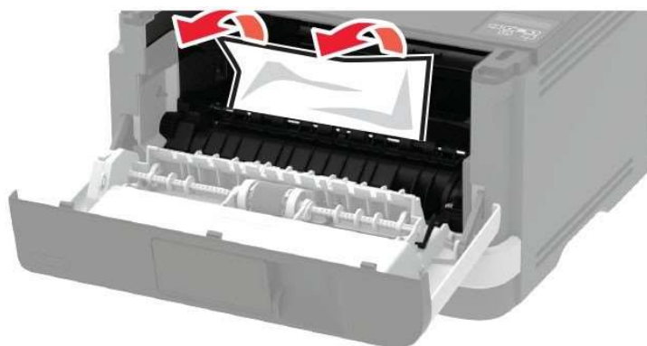
Рисунок 23 – Извлечение замятой бумаги из многоцелевого устройства подачи.
